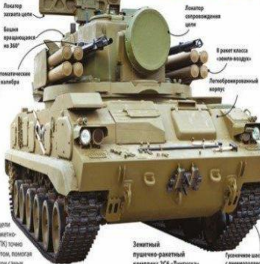
Гусеничное шасси с пневмоподвеской
